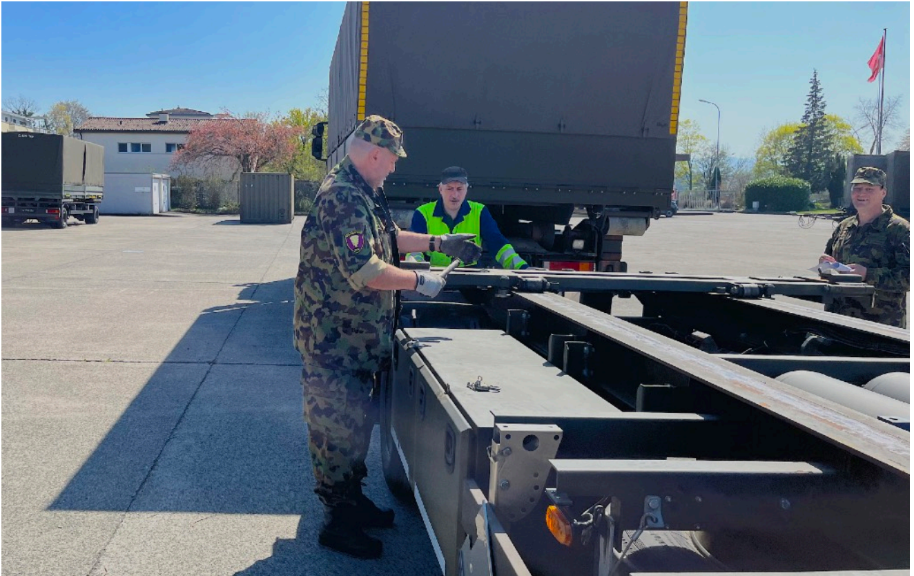
der Schlittenananhänger kann sowohl Abrollbehälter, als auch ISO-Container aufnehmen
