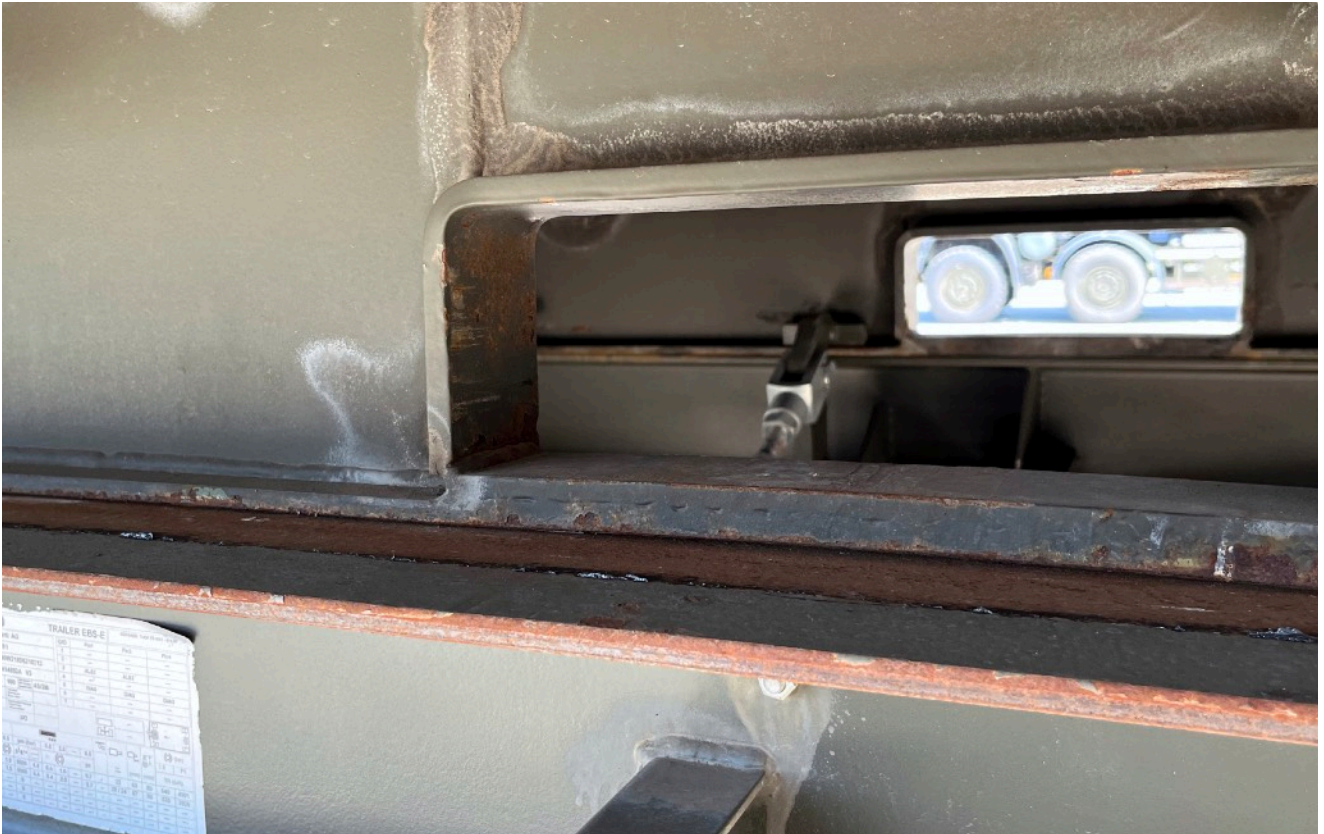
gut sichtbar eine von vier Klemmbacken für die Sicherung eines Abrollbehälter
