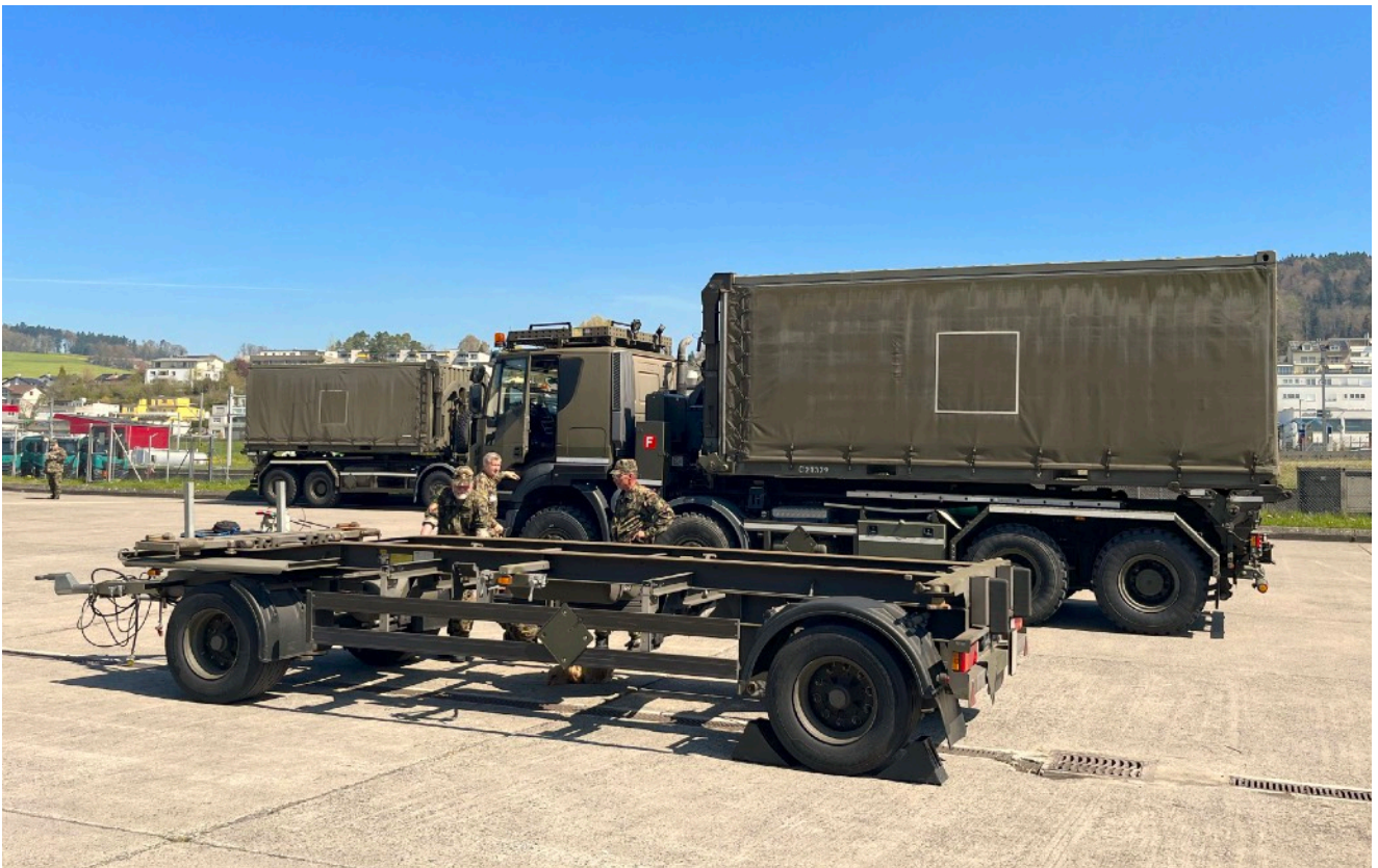
dieser Schlittenanhänger ist ebenfalls Teil des Wechselladesystem (WLS)
